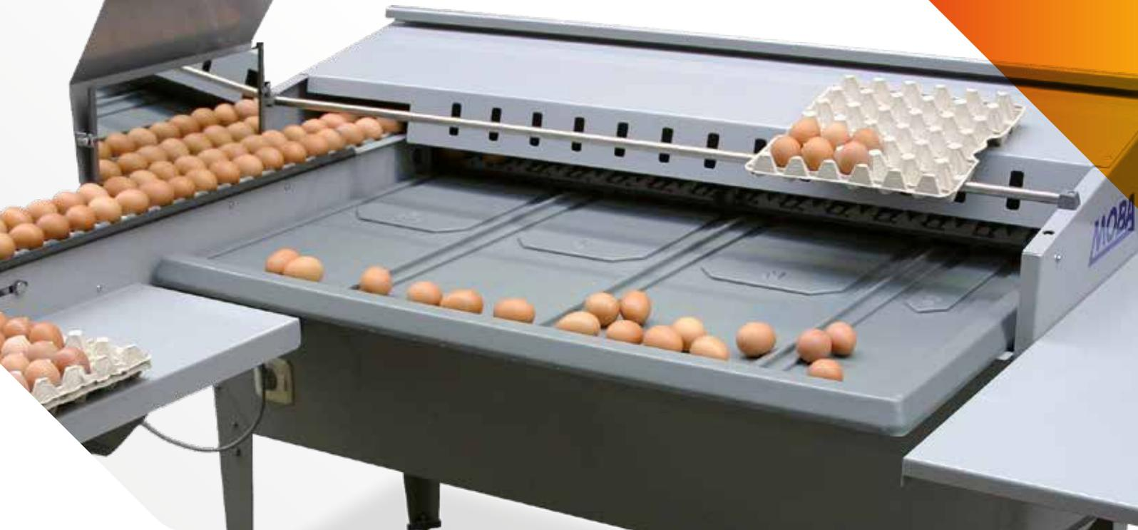
wartungsfrei ihre Arbeit leistet. Der Absammeltisch ist aus Industriekunststoff und dadurch leicht zu reinigen.
